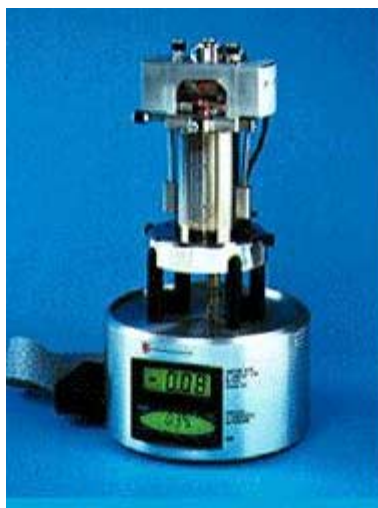
Figura.7.36. Modelo de microscópio de força atômica (AFM).
